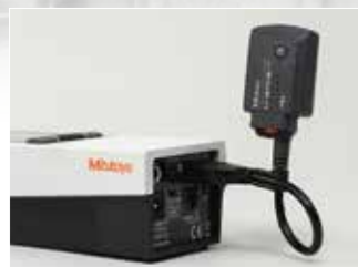
Voorbeeld van aansluiting op een SJ-210
